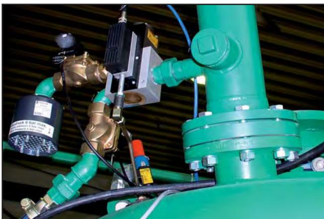
Regelung des Kammerdrucks mittels Proportionalventil und selbstreinigender Filterkerze
